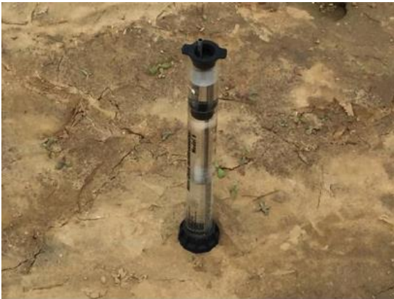
Fig. 17 Mini disk infiltrometer 試験
